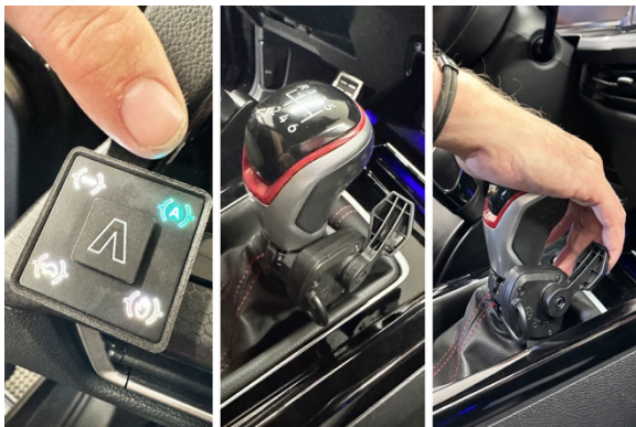
Schaltgetriebe neu gedacht: Die Kupplungsfunktion wird elektronisch unterstützt, verschiedene Betriebsarten lassen sich über ein separates Bedienfeld wählen. Foto: Paravan.
