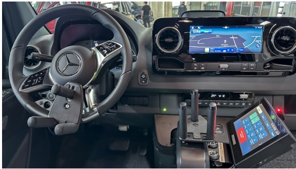
Individuelle Steuerung im Detail: Dreizack-Lenkhilfe und Gas-Bremsschieber ermöglichen die präzise Bedienung des Fahrzeugs. Foto: Paravan
