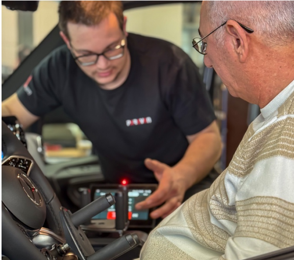
Individuelle Anpassung im Detail: Cahit bei der Feinabstimmung seiner Fahr- und Bedienhilfen – im direkten Austausch mit einem Paravan Techniker. Foto: Paravan
