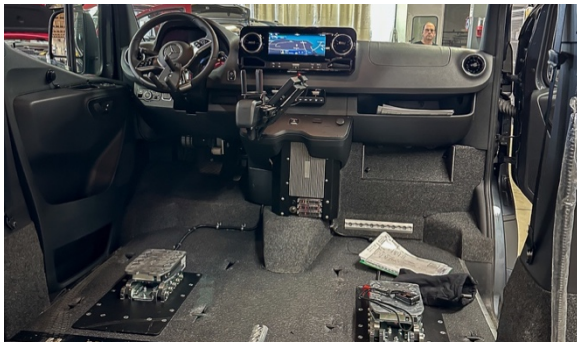
Flexibles Innenraumkonzept: Schienensystem und Dockingstationen ermöglichen die sichere Integration des Rollstuhls als Fahrersitz. Foto: Paravan
