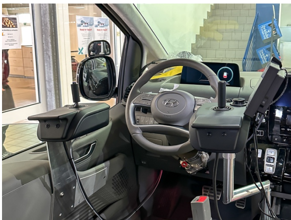
Der Paravan Hyundai Staria wird über zwei Joysticks gesteuert. Grundlage dafür ist das elektronische Fahr- und Lenksystem Space Drive. Foto Paravan
