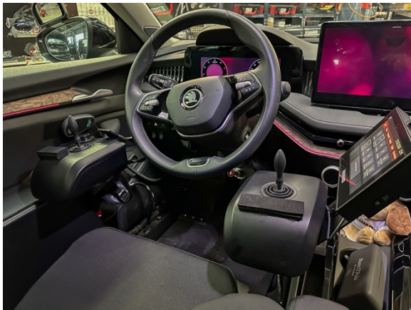
Individuelle Fahrzeuganpassung im Detail: Steuerung über Joysticks und Paravan Touch für maximale Selbstständigkeit. Foto: Paravan
