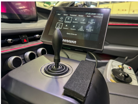
Intuitive Bedienung: Paravan Touch und Joystick ermöglichen die Steuerung aller Fahrzeugfunktionen. Foto: Paravan
