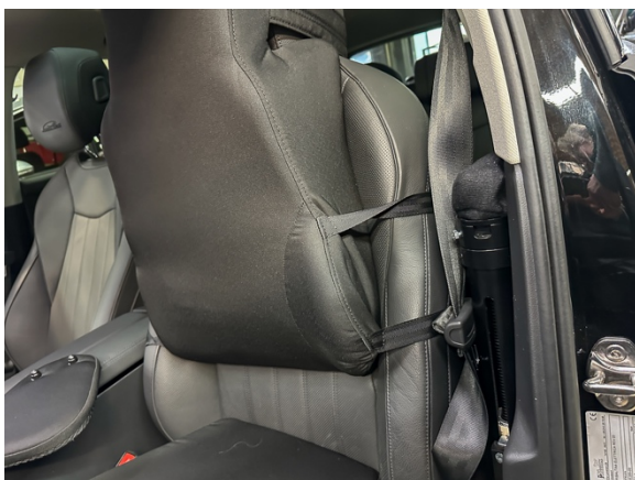
Individuell angepasst: Ergonomisches Rückenpolster sorgt für Stabilität und komfortables Fahren. Foto: Paravan
