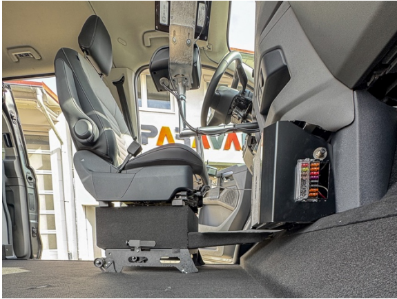
Flexible Fahrerposition: Auf einer Paravan Schnellwechselkonsole montiert, lässt sich der Original-Fahrersitz schnell ausbauen und schafft Platz für den Rollstuhl am Fahrerplatz. Foto: Paravan
