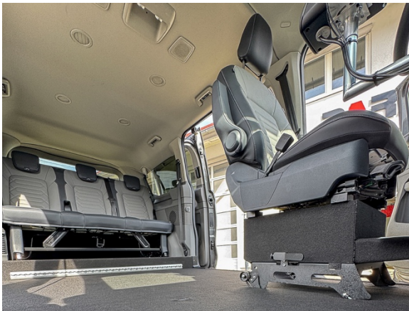
Durchgehender, tiefergelegter Fahrzeugboden: Der Paravan Umbau der VW New Caravelle schafft eine großzügige Durchfahrfläche vom Einstieg bis in den Fahrerbereich. Foto: Paravan
