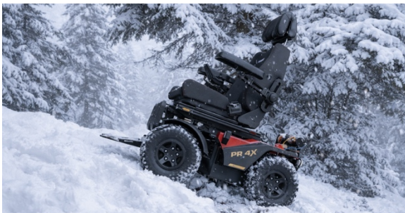
Outdoor-Elektrorollstuhl für anspruchsvolles Gelände: Der Paravan PR 4X mit Allradantrieb, erhöhter Bodenfreiheit und robuster Fahrwerksauslegung ermöglicht Mobilität auch abseits befestigter Wege. Foto: Paravan/ KI
