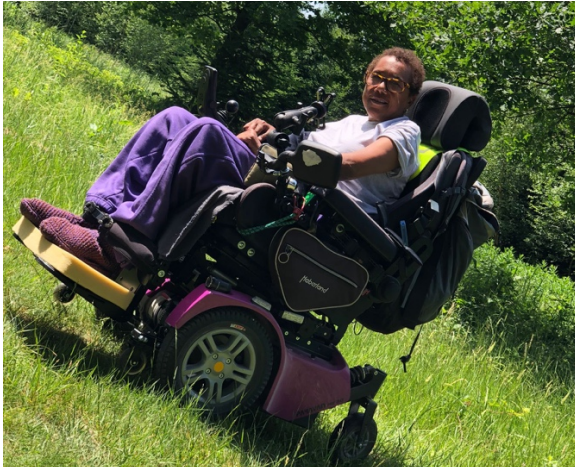
Der Paravan PR 30/II (HMV-Nr.: 18.99.06.1143): Vielseitiger Elektrorollstuhl mit komfortabler Federung, elektrischer Kante- und Liegefunktion sowie individuell konfigurierbaren Sitzsystemen für unterschiedliche Versorgungsanforderungen. Foto: Paravan
