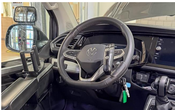
Lenken, Gas geben und bremsen – alles per Hand: Das individuell angepasste Cockpit ermöglicht Sabina ein sicheres und ermüdungsfreies Fahren mit höchster Präzision. Foto: Paravan
