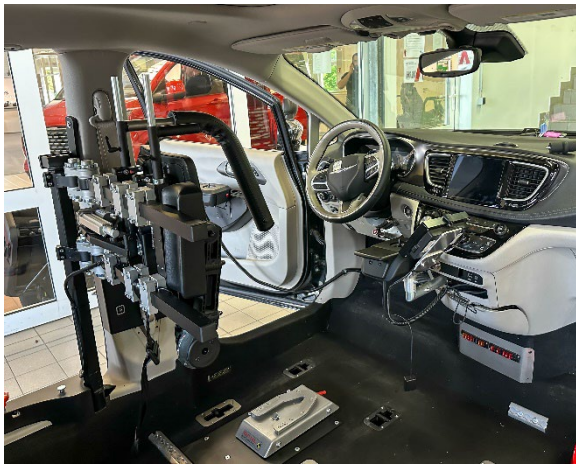
Technik trifft Präzision: Spezialhalterungen, Dockingstation und elektronische Steuerung machen das Fahrzeug passgenau für Jana. Foto: Paravan.
