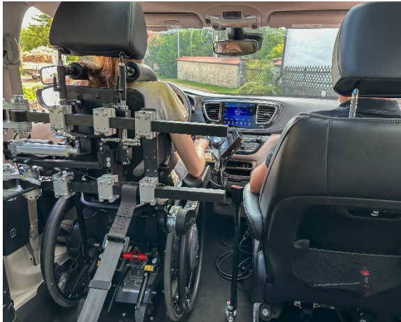
Technik, die bewegt: Dank Joysticksteuerung und Spezialhalterungen fährt Jana wieder selbstständig. Foto: Paravan.
