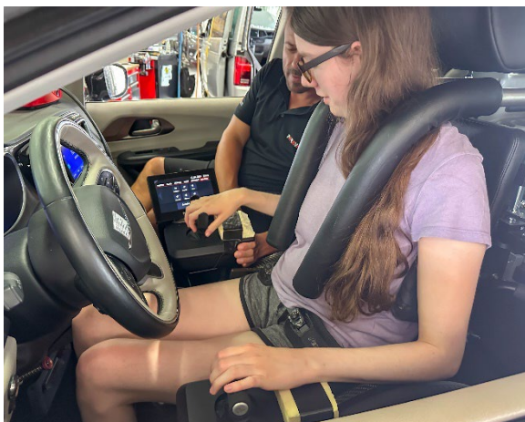
Gemeinsam zur optimalen Lösung: PARAVAN-Techniker passen das Space Drive System exakt an Janas Bedürfnisse an. Foto Paravan:
