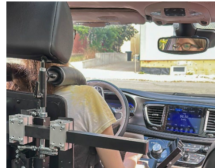
Technik trifft Präzision: Spezialhalterungen, Dockingstation und elektronische Steuerung machen das Fahrzeug passgenau für Jana. Foto: Paravan.
