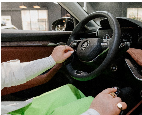
Kristina Vogel steuert ihren Škoda Superb per Handbedienung für Gas und Bremse – ergänzt durch einen Multifunktionsschalter zur Bedienung aller wichtigen Sekundärfunktionen. Foto: Škoda/Dammanworks
