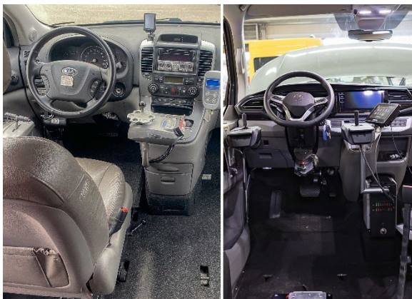
Zwei Cockpits im Vergleich – dazwischen liegen 16 Jahre. Wo früher viele Knöpfe nötig waren, um die Sekundärfunktionen zu bedienen, gibt es heute Sprachsteuerung und den PARAVAN Touch. Das bedeutet ein großes Plus an Komfort und Sicherheit. Foto: Paravan
