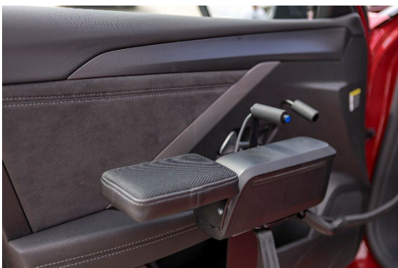
Das Gas bzw. Bremspedal bedient Monika mit einem Gas-Brems-Schieber mit der linken Hand, optimal platziert, dass es nicht zur Ermüdung während der Fahrt kommt. Damit Sie trotzdem noch ohne Probleme die Fahrtür öffnen kann, wurde der Hebel verlängert. (der vordere). Der Teufel steckt bei der Anpassung immer im Detail.
