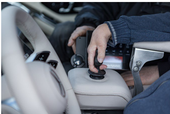
Durch die optimale Auflage muss der Arm bequem positioniert sein, ohne dass die Bewegungsfreiheit nach recht links (Lenkung) oder nach vorn und hinten (Gas und Bremse) eingeschränkt ist. Foto: PARAVAN
