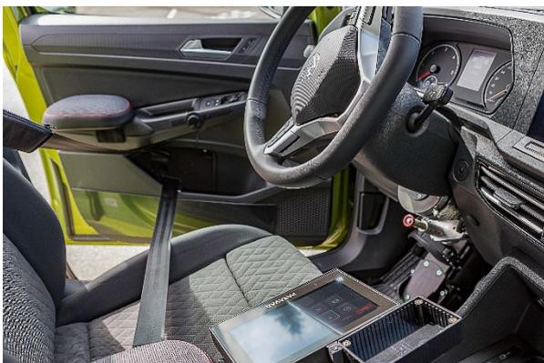
*Ziel jeder PARAVAN-Mobilitätslösung ist die Flexibilität und Unabhängigkeit für den Kunden mit Handicap. Das heißt aber auch, dass er ohne fremde Hilfe ins Auto hineinkommen muss. Das geschieht hier mit Hilfe einer elektrischen Türöffnung. Der Dreipunktgurt ist in der Tür angebracht, und so kann Ingrid Höhlung ohne Problem allein im Auto Platz nehmen und losfahren. Foto: PARAVAN*
