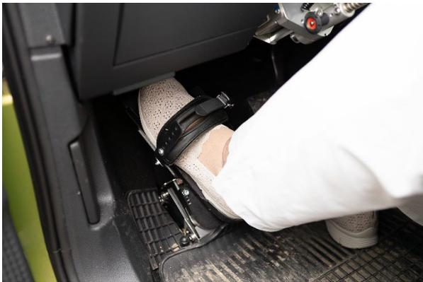
*Wenn die Arme nicht mehr funktionieren, bleibt nur noch der Fuß. Dank Space Drive ist das jedoch kein Problem. Das Eingabegerät an der elektronischen Lenkung kann ohne Probleme auch im Fußraum platziert werden. Foto: PARAVAN*
