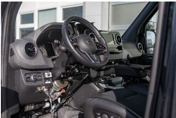
Der neue Mercedes Sprinter der PARAVAN-Fahrschule bietet viele Möglichkeiten und ist je nach Bedarf sehr schnell umgerüstet, vom einfachen mechanischen Handbediengerät bis zum elektronischen Fahr- und Lenksystem Space Drive. Foto: PARAVAN
