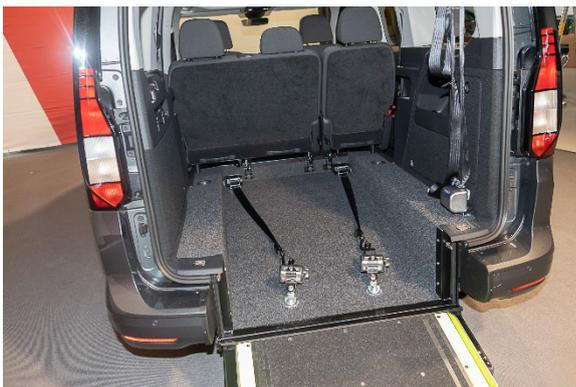
*Mit an Bord des barrierefreien VW Caddy Maxi 5 für Avis ist ein komplettes Rollstuhlbefestigungssystem nach dem Kraftknotenprinzip sowie ein Drei-Punkt-Gurt für den Passagier im Rollstuhl, Foto: PARAVAN*
