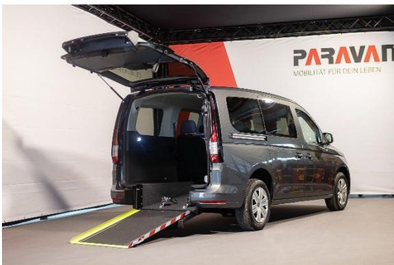
*Der VW Caddy Maxi 5 ist mit einer Heckrampe und den entsprechenden Befestigungen ausgestattet. Damit kann ein Rollstuhlfahrer ohne Probleme im Fahrzeug mitfahren – egal ob Aktiv- oder Elektrorollstuhl, Foto: PARAVAN*
