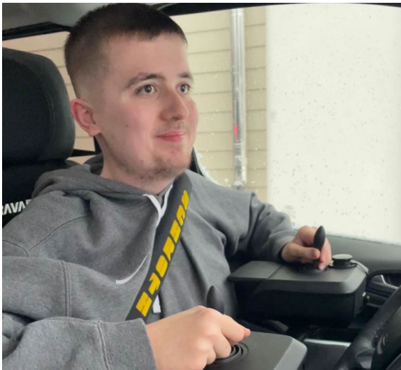
Lukas ist wieder mobil. Sein Cockpit ist modular konzipiert. Die Joysticks, die Lukas zum Fahren benötigt können jederzeit abgenommen werden, wenn einmal jemand anderes vor dem Steuer sitzt. Foto: PARAVAN
