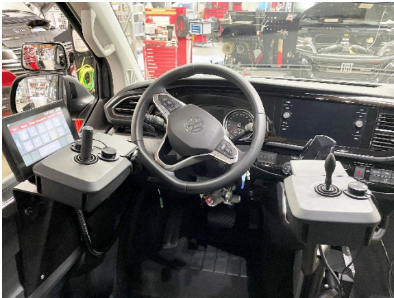
Ein bisschen sieht es in Udos Auto aus wie in einem Flugzeug-Cockpit. Viele Knöpfe und Hebelchen sorgen dafür, dass Udo sein Auto ohne Fremde Hilfe selbstständig bedienen kann. Foto: PARAVAN
