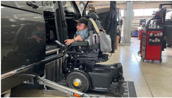
Per Knopfdruck öffnet sich die Tür von Udos VW T6.1. Über den Kassettenlift kommt er ohne Probleme ins Auto. Foto: PARAVAN
