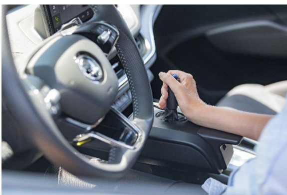
Steuern wird Svenja ihr Fahrzeug mit dem Drive-by-Wire System Space Drive und zwei Joysticks. Mit der linken Hand betätigt sie Gas und Bremse, mit der Rechten lenkt sie und kann die wichtigsten Sekundärfunktionen per Knopfdruck bedienen. Foto: PARAVAN
