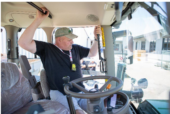
Zum Umsetzen wurden extra überall Haltegriffe verbaut, damit ein Umsetzen auch in die Fahrgastzelle jederzeit unproblematisch möglich ist und Edmund Ödamer überall sicheren Halt hat. Foto PARAVAN
