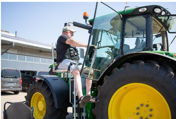
Mittels individuell angepasstem Liftsystem kann Edmund Ödamer in das Fahrerhaus seines John Deere Traktors fahren, Foto PARAVAN
