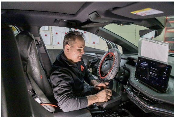
Feinschliff vor der Anpassung mit dem Kunden. PARAVAN-Techniker Daniel Haberbosch prüft noch mal das Space Drive System und die Anpassungen am Fahrzeug. Foto: PARAVAN
