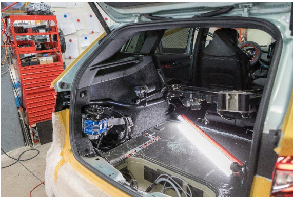
Eine anspruchsvolle Konstruktion: aus dem Kofferraum fährt der Transportarm des Robot 3000 Maximum bis zur Fahrertür um den Rollstuhl aufzunehmen. Foto: PARAVAN
