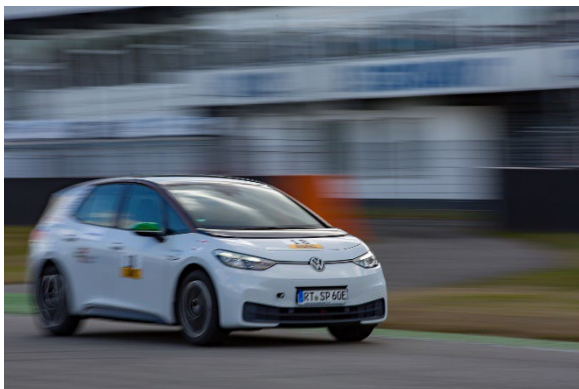
Der VW ID3 #18 kommt dank Space Drive ohne mechanische Verbindung zwischen Lenkeinheit und Lenkgetriebe aus. Die 24h-ecompetition ist ein ideales Testfeld für die Erprobung der Technologie in einem Straßenfahrzeug. Foto: Schaeffler-Paravan
