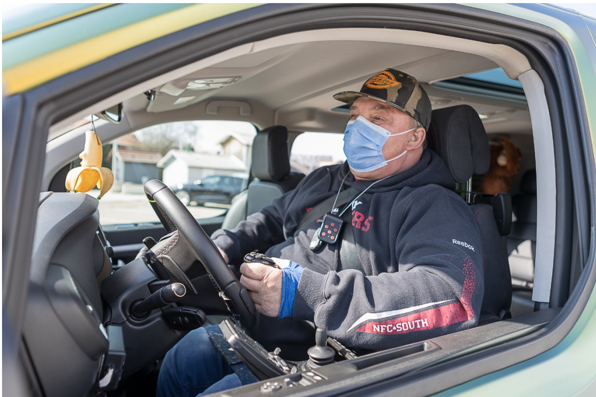
Jetzt sitzt Hans Joachim Cornelius wieder selbst am Steuer. Mit der „leichten Bremse“ kann er sein Fahrzeug nun sicher manövrieren. Als Lenkhilfe dient ihm zusätzlich noch ein Multifunktionsknopf. Foto: PARAVAN
