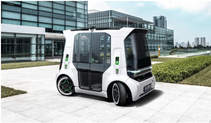
Plattformkonzept „Schaeffler Mover“ ist rein elektrisch angetrieben und kann in urbanen Räumen zum Beispiel für flexible Transportaufgaben eingesetzt werden. Foto:Schaeffler-Paravan
