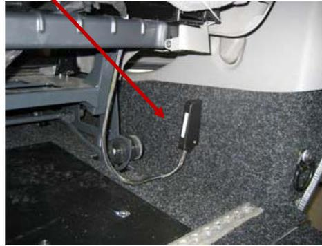
Griff an der rechten Seite der Sitzkonsole entriegeln und zum Lösen des Sitzes bis zu seinem Endanschlag nach hinten ziehen. Danach den Sitz etwas zurückziehen und nach hinten abkippen. So können die Sitze bequem und ohne großen Kraftaufwand aus dem Fahrzeug gerollt werden.
