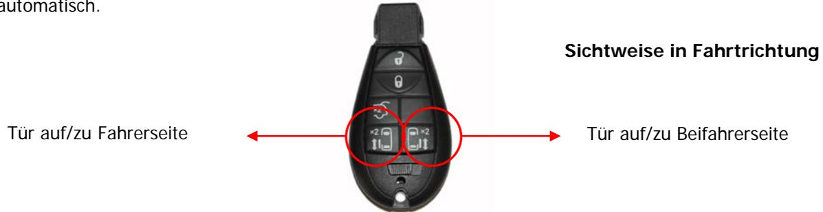
Um die Tür auf der Fahrerseite zu öffnen betätigen Sie den linken Taster der Fernbedienung. Zum Öffnen der Tür auf der Beifahrerseite betätigen Sie den rechten Taster auf der Fernbedienung. Nach dem Öffnen der Tür, drücken Sie die **(1)** auf der PARAVAN Fernbedienung. Das Fahrzeug senkt sich um ca. 10 cm ab, und die Rampe fährt aus dem Rampenfach.
