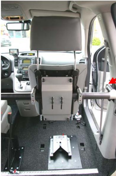
Zum Einsetzen des abnehmbaren Teils wird auf der rechten Seite (an der B-Säule) ein Riegel in die Bohrung der Arretierplatte eingesteckt.
