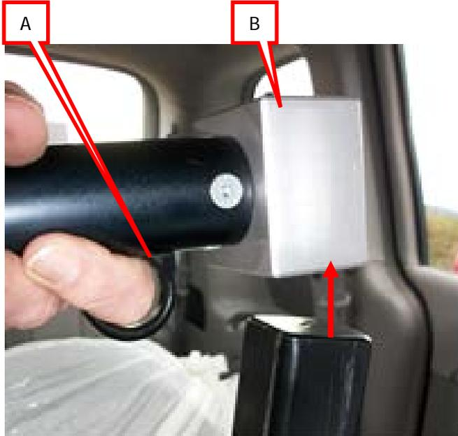
Den Pistolengriff(A) der Arretierung anziehen, dadurch den Arretierbolzen aus der Verankerung lösen und langsam nach oben ziehen, bis der U- förmige Riegel(B) wieder frei über der Mittensäule beweglich ist.
