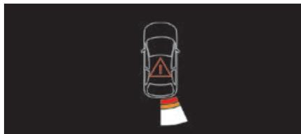
Sie ergänzt, unabhängig von der Fahrtrichtung des Fahrzeugs, die akustische Hilfe durch Anzeige von Segmenten auf dem Bildschirm,
