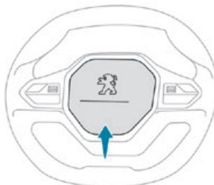
► Drücken Sie auf den mittleren Bereich des Lenkrads.
