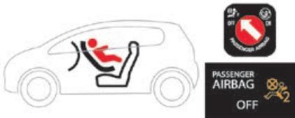
! Der Beifahrer-Front-Airbag muss **deaktiviert** werden, bevor ein Kindersitz auf dem Beifahrersitz „entgegen der Fahrtrichtung“ eingebaut wird. Andernfalls **könnte das Kind beim Entfalten des Airbags schwere oder sogar tödliche Verletzungen** erleiden.
