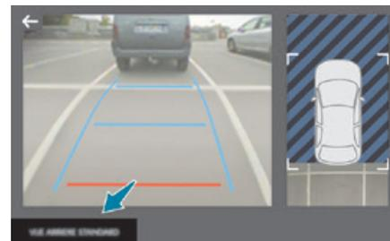
Um die Kamera, die sich an der Heckklappe befindet, zu aktivieren, legen Sie den Rückwärtsgang ein und fahren Sie nicht schneller als 10 km/h.
