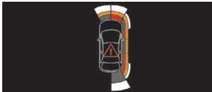
Mit vier zusätzlichen Sensoren an den Seiten am vorderen und am hinteren Stoßfänger erfasst das System die Position von feststehenden Hindernissen während des Manövers und signalisiert sie, wenn sie sich neben den Seiten des Fahrzeugs befinden.
