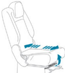
► Heben Sie den Bügel an und schieben Sie den Sitz nach vorne oder hinten.
