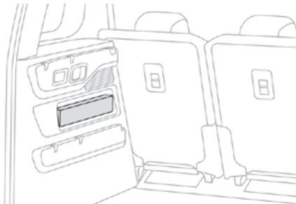
In der Innenverkleidung des Kofferraums befindet sich ein Staufach zur Aufnahme des Warndreiecks.
