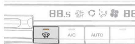
**i** ► Drücken Sie diese Taste, um die niedergeschlagene Feuchtigkeit oder Eis von der Windschutzscheibe und den Seitenscheiben schneller zu beseitigen. Klimaanlage, Luftstrom und Frischluftzufuhr werden nun automatisch gesteuert und die Luft optimal auf Windschutzscheibe und Seitenscheiben verteilt.
