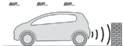
Das System signalisiert das Vorhandensein von Hindernissen sowohl innerhalb des Sensorerkennungsbereichs als auch im Fahrzeugweg, der durch die Ausrichtung des Lenkrads bestimmt wird.
