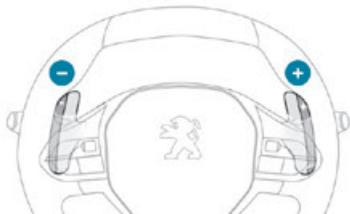
▶ Ziehen Sie am Schalter rechts „+“, um hochzuschalten, oder am Schalter links „-“, um herunterzuschalten.
