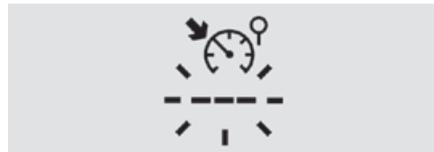
Das Anzeigen von Strichen (erst blinkend, dann ununterbrochen) weist auf eine Funktionsstörung des Geschwindigkeitsreglers hin. Lassen Sie das System von einem Vertreter des PEUGEOT-Händlernetzes oder in einer qualifizierten Fachwerkstatt überprüfen.
