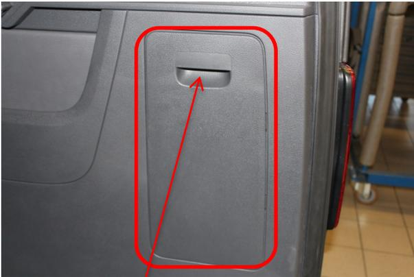
Auf der rechten Kofferraum Seite, hinter dieser Abdeckung befindet sich die „Notventilbefüllung“. Die Abdeckung ist mittels der Griffmulde herauszunehmen. **Bei der Notbefüllung sind max. 6,5 bar**
