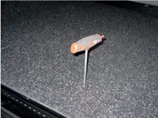
Abb. 4: Schraube zur Notentriegelung unter dem Teppich
