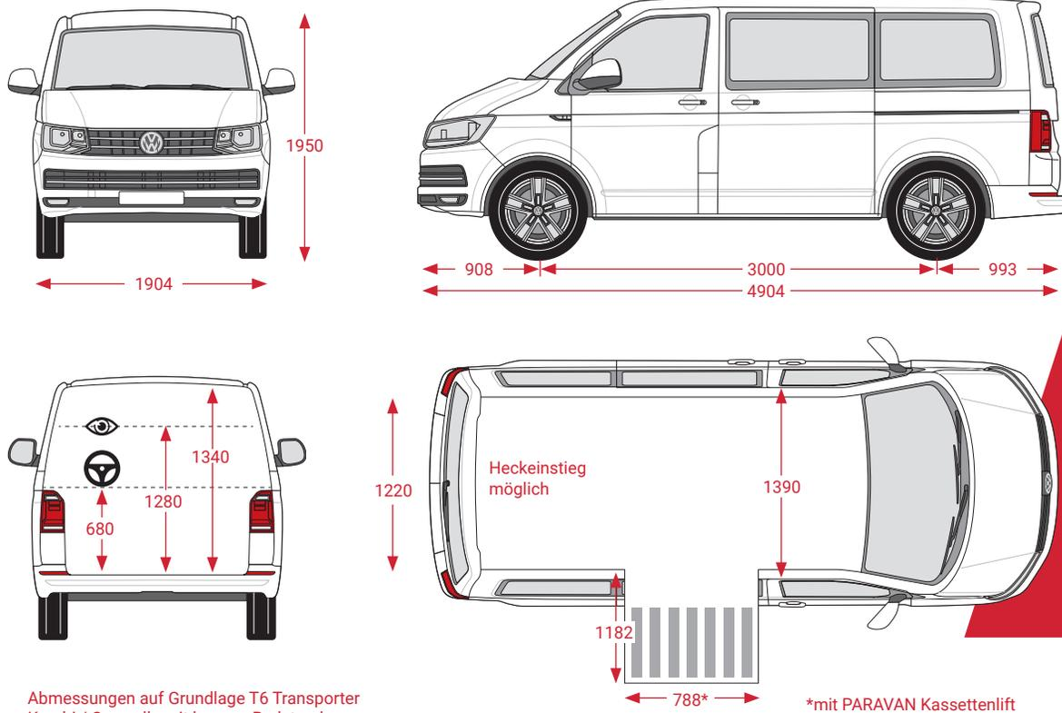
Abmessungen auf Grundlage T6 Transporter Kombi / Caravelle mit kurzem Radstand
