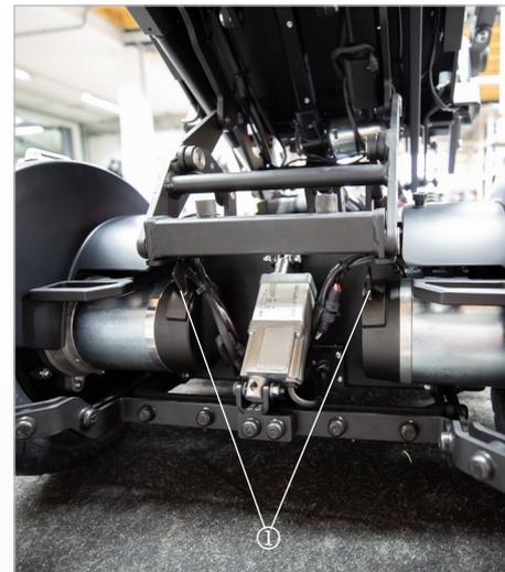
Abb. 30: Bremsentriegelungshebel (Notentriegelung)
