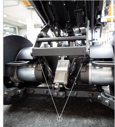
Abb. 28: Bremsentriegelungshebel (Notentriegelung)
