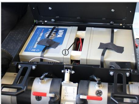
Abb. 106: Energiekupplung
