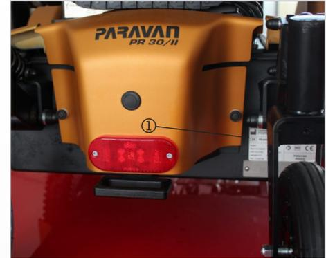
Abb. 6: Positionsort Typenschild
