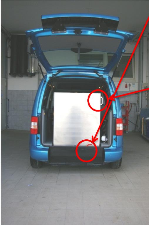
Entriegeln der Rampe durch Ziehen des Griffs. Danach kann die Rampe mit Hilfe des Haltegriffs manuell ausgeklappt werden.
