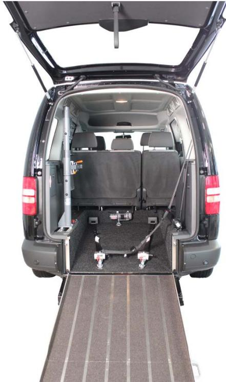
Klappen Sie die Rampe mit Hilfe des Haltegriffs wieder manuell nach oben bis die Rampe automatisch im Heckbereich einrastet. Anschließend können Sie die Heckklappe des Fahrzeugs schließen.
