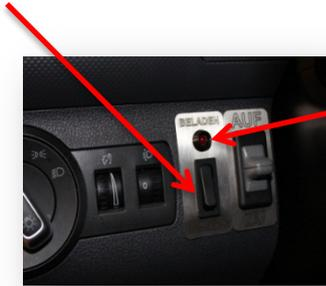
Solange die LED-Leuchte in diesem Bedienelement blinkt, werden die Luftbälge noch befüllt. Erst wenn diese LED-Leuchte nicht mehr leuchtet/ blinkt, ist das Fahrzeug fahrbereit!
