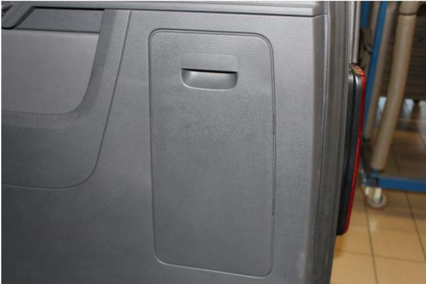
Auf der rechten Kofferraum Seite hinter dieser Abdeckung befindet sich die „Notventilbefüllung“. Die Abdeckung ist sehr leicht herauszuklappen. **Bei der Notbefüllung sind max. 6,5 bar einzufüllen!!!**
