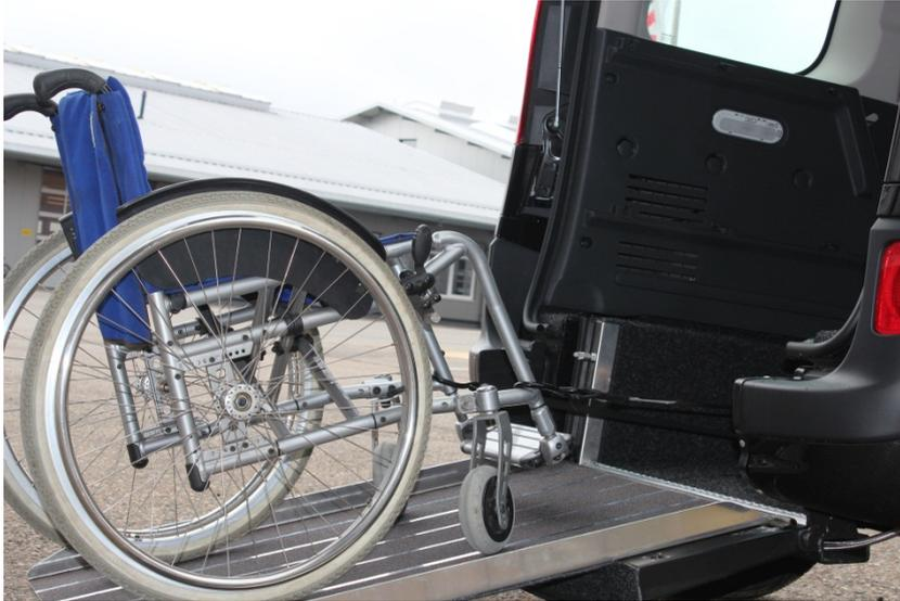
Die vorderen elektrischen Gurte werden am Rollstuhl eingehängt. Der Rollstuhl wird bis zum Ende der Kassette vorgefahren. Durch erneutes Umlegen des Schalters sind die Gurte gesperrt. Der Rollstuhl kann nicht mehr zurückrollen.
