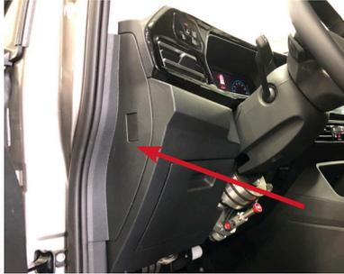
Abb. 17: Position Sicherungskasten
