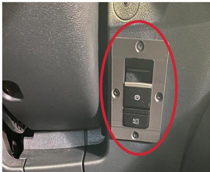
Der Schalter der serienmäßigen Parkbremse wurde lediglich verlegt und befindet sich nun zwisch Lenksäule und Mittelkonsole.
