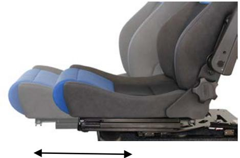
Die einfache elektrische Längsverstellung.
