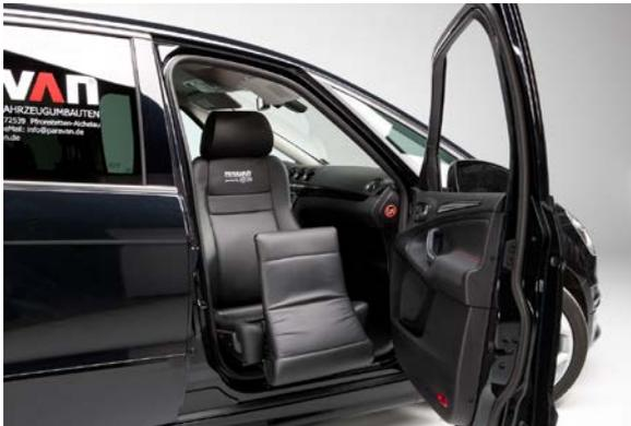
Fahrzeugspezifische Einbaukonsole für die Paravan Schwenksitzkonsole.
