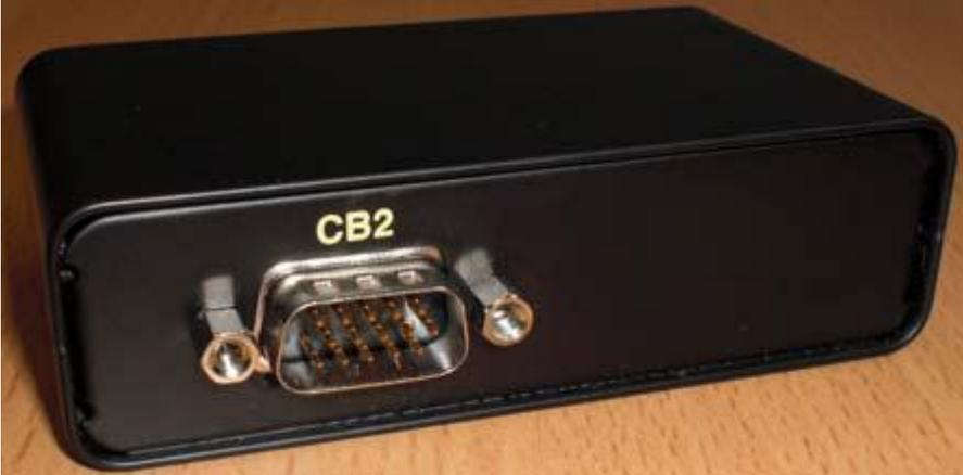
Mit dem manuellen Kontrollgerät können die Motoren des Robot 3000 einzeln bedient werden, wenn das automatische System eine Fehlfunktion aufweist. Jedem Motor des Robot ist dabei einem Schalter mit den Funktionen in / out zugeordnet. Durch Drücken dieser Schalter lässt sich der Robot 3000 nach und nach entlang des gewünschten Weges bewegen.
