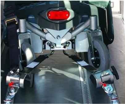
Die hinteren Gurte werden mittels der Retraktoren auf der Aluschiene oder auf den „Bodenpilzen“ befestigt. Die Retraktoren werden jeweils auf der Höhe der hinteren Rollstuhlräder seitlich am Rollstuhlrahmen befestigt.
