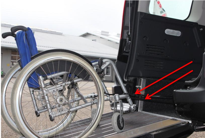
Die elektrischen vorderen Gurte werden am Rollstuhl eingehängt. Durch erneutes Umlegen des Schalters schalten Sie diesen aus (rote Leuchte geht aus). Die Rückrollsicherung für den Rollstuhl ist somit aktiviert.
