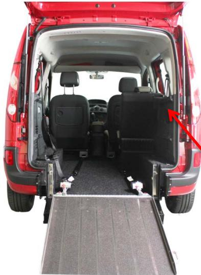
Nachdem die Rampe geöffnet ist, können die elektrischen vorderen Gurte durch Umlegung des Schalters (rotes Licht leuchtet) herausgezogen werden.
