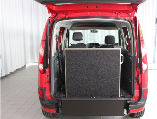
Klappen Sie die Rampe mit Hilfe des Haltegriffes wieder manuell nach oben bis die Rampe automatisch im Heckbereich einrastet. Anschließend können Sie die Heckklappe des Fahrzeugs schließen.
