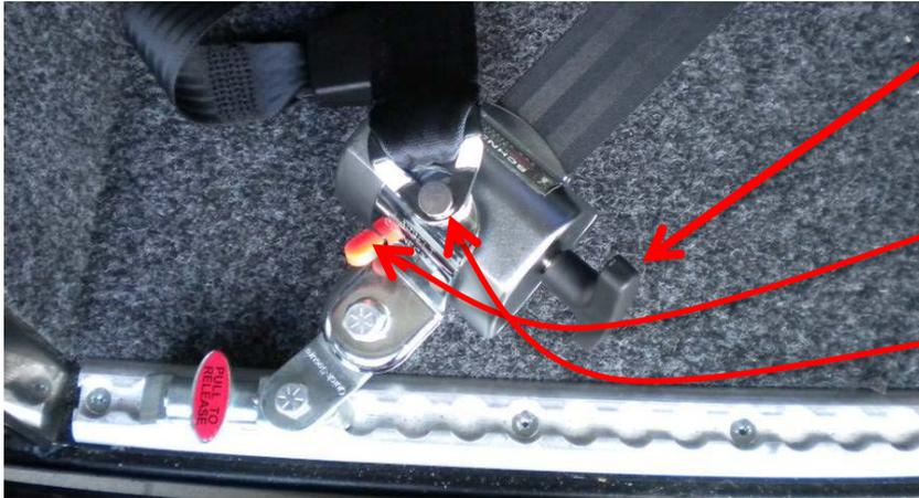
Die Hinteren- Gurte können mittels des Handspannrades gespannt werden (durch Drehen des Handspannrades).
