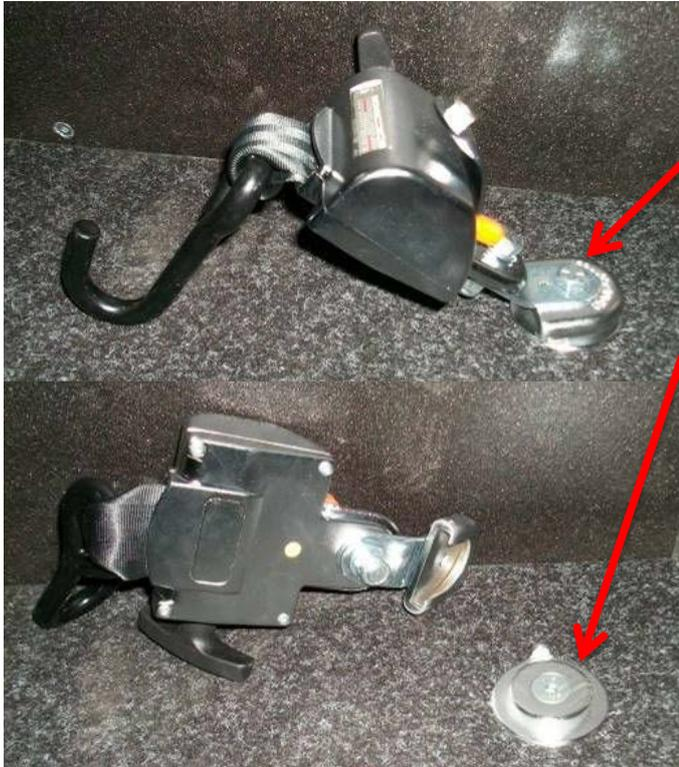
Bei einer Pilz- Arretierung kann der Retraktor durch eine Drehung gelöst werden.
