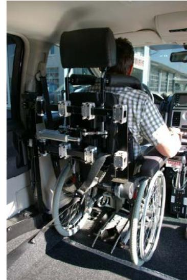
**A:** automatisch bewegliche Kopf- und Rückenstütze; **B:** individuell verstellbares Rückhaltesystem (hier: Bügelsystem); **C:** elektrisch verstellbare Armlehne; **D:** Befestigung an der B-Säule.
