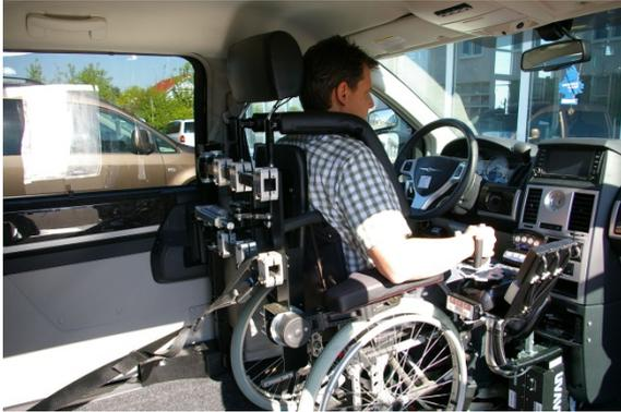
Das elektrisch bedienbare Rückhaltesystem der Kopf- und Rückenstütze ersetzt den herkömmlichen Dreipunktgurt. Ein selbständiges Angurten ist daher auch mit einer starken Bewegungseinschränkung möglich. Zudem sichert und stabilisiert die Kopf- und Rückenstütze den Oberkörper, sowie den Kopf des Fahrers.
