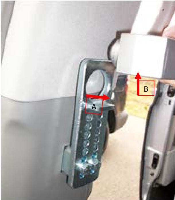
Anschließend den Riegel an der B-Säule aus der Arretierplatte lösen und die Kopf- und Rückenstütze vorsichtig entfernen.
