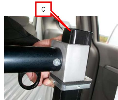
Durch das nach hinten ziehen des Pistolengriffs(A) lässt sich der U- förmige Riegel(B) sehr einfach über die Mittensäule(C) schieben und soweit nach unten bewegen, bis die Arretierung in die dafür vorgesehene Bohrung der Mittensäule einrastet.
