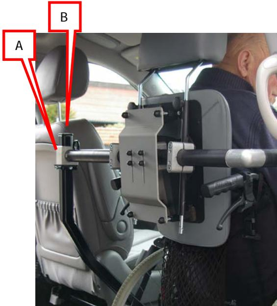
Auf der linken Seite muss anschließend der U-förmige Riegel(A) über die Mittensäule(B) geschoben werden, bis dieser in der vorgesehene Bohrung verankert.
