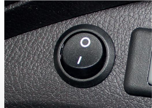
Abb. 4: Schalter für Absenkung
