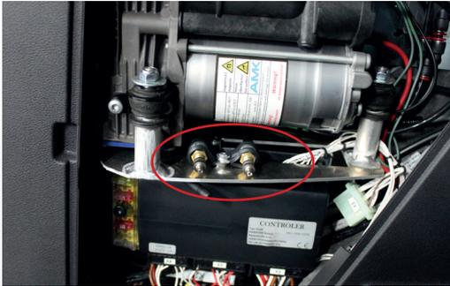
Abb. 17: Notbefüllung Luftfahrwerk
