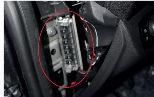
Abb. 15: Sicherungen A-Säule
