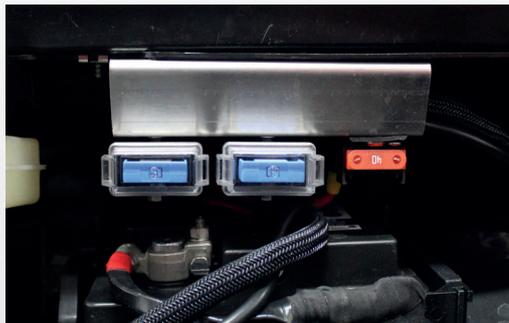
Abb. 16: Sicherungen im Motorraum
