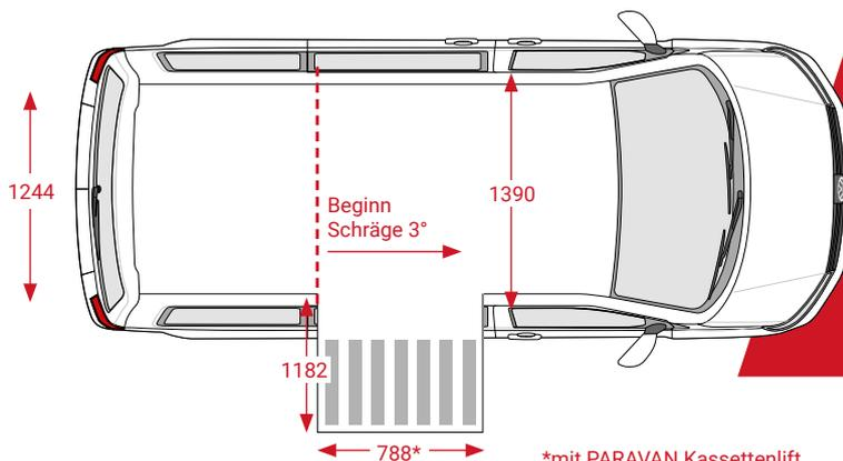
Abmessungen auf Grundlage T6 Transporter Kombi / Caravelle mit kurzem Radstand
