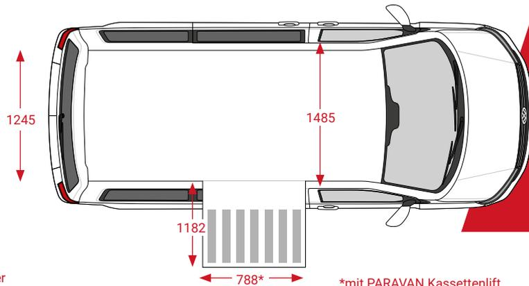
Abmessungen auf Grundlage T6.1 Transporter Kombi / Caravelle mit kurzem Radstand
