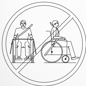
Abb. 44: Abbildung eines unsachgemäßen Gurtsystems Verladen und Transport des Elektrorollstuhls
