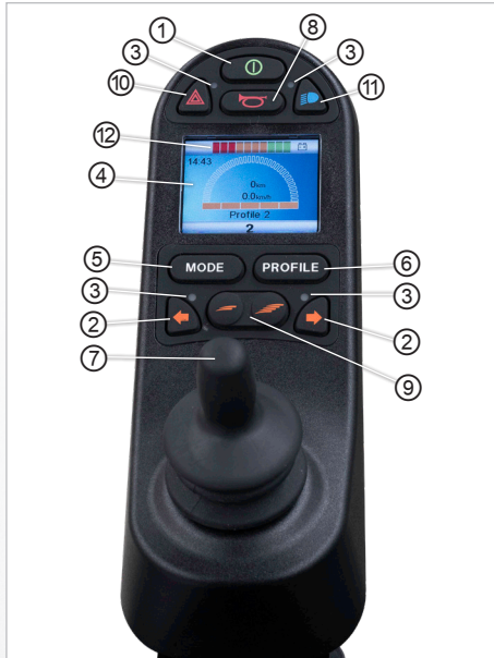
Abb. 71: Fahrpult R-NET CJSM-L
