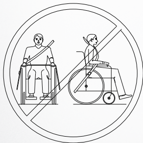
Abb. 29: Abbildung eines unsachgemäßen Gurtsystems
