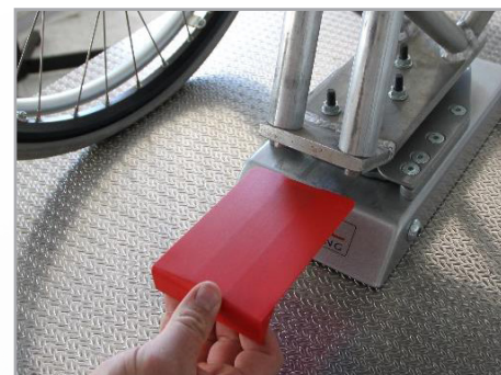
Abb. 47: Manuelle Entriegelung Schritt 1
