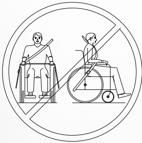
Abb. 30: Abbildung eines unsachgemäßen Gurtsystems
