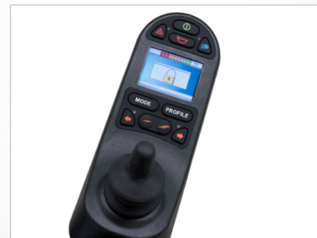
Abb. 91: Steuerung sperren - Sperrsymbol
